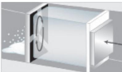
*Cold Jet's patentierte Abschabedosiertechnologie erstellt komprimierten Trockeneisschnee nach Bedarf.*
