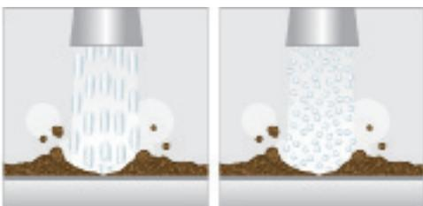
*Schalten Sie einfach auf Pelletreinigung um grobe und hartnäckige Verschmutzungen zu entfernen.*
